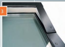
Il fermavetro perimetrale esterno, è totalmente coperto dai carter di alluminio per offrire la massima garanzia di tenuta. I carter di copertura sono coibentati, nella parte interna, per evitare eventuali gocciolamenti di condensa.
