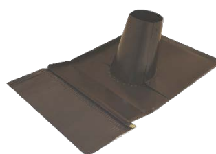
Conversa in alluminio T.Moro regolabile con faldale rialzato in alluminio plissettato sagomabile. Comprende fascia butilica per adesivare alla tegola
