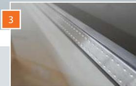
Vetrata: interno 4 basso emissivo/14 argon/3+3 esterno, con canalina a bordo caldo per migliorare la prestazione termica del serramento e limitare ulteriormente la formazione di condensa lungo il perimetro dell'anta (Uw=1.35 Ug=1.1)
