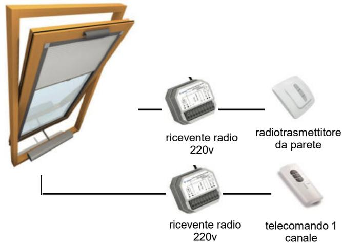
Dati tecnici ricevente: Tensione nominale 230-240v AC/50Hz
