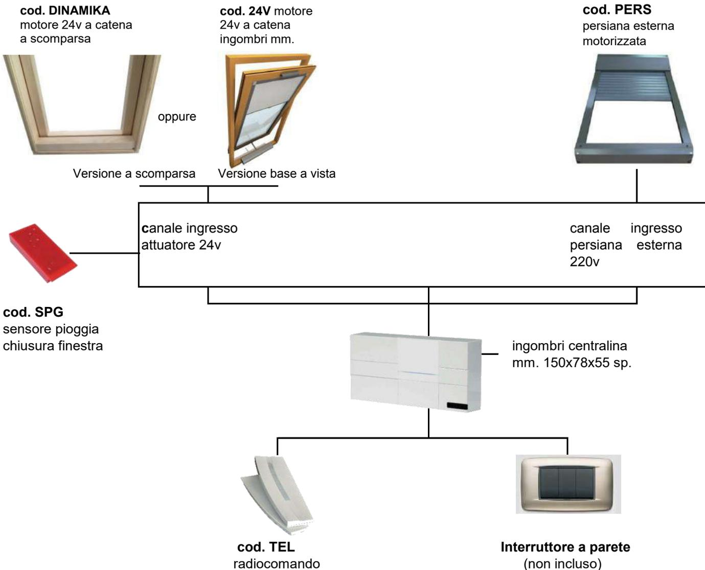
Si consiglia la predisposizione dell'alimentazione elettrica con un tubo corrugato nella parte bassa della soletta per eventuale motorizzazione finestra ed un tubo corrugato comunicante con l'esterno per applicazione della tapparella esterna e o del sensore pioggia.
